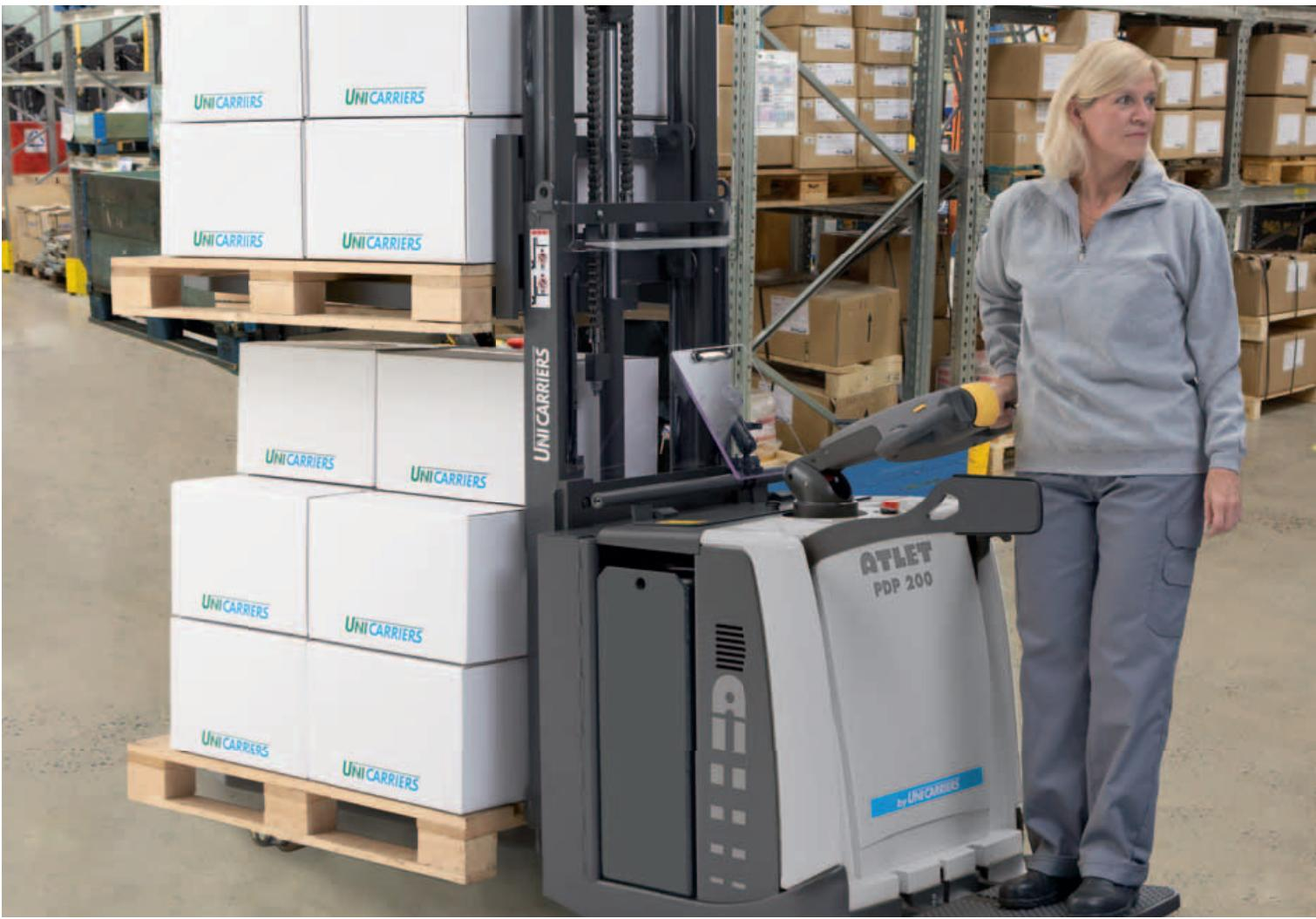
Schmaler als eine Europalette hat der PDP 200 eine Gesamtkapazität von 2.000 kg (1.000 kg + 1.000 kg im Doppelpalettenhandling) und eine maximale Hubhöhe von 2.090 mm. Sein 2,2 kW AC-Antriebsmotor und die Fahrgeschwindigkeit von bis zu 12,5 km/h tragen zu dem einzigartigen Palettdurchfluss dieses effizienten Doppelstock-Staplers mit Fahrerstandplattform (optional) bei.
